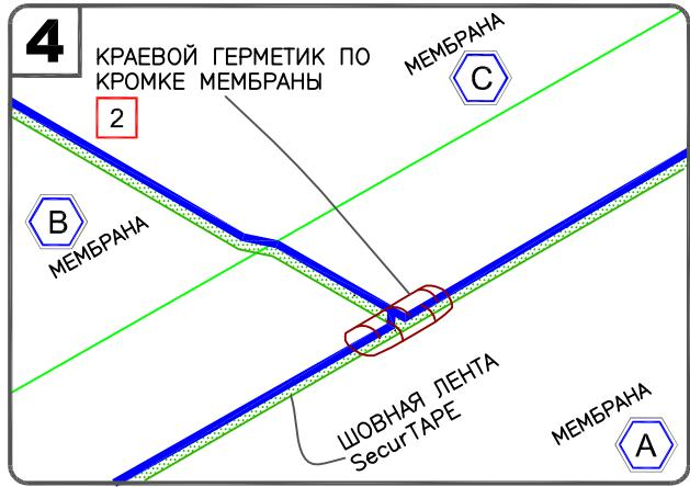
СОЕДИНТЕ ПОЛТОНО **С** С ПОЛОТНАМИ **А** И **В**. ПРИЖМИТЕ РУКОЙ ВЕРХНЕЕ ПОЛОТНО К НИЖНЕМУ ПО НАПРАВЛЕНИЮ К КРАЮ МЕМБРАНЫ В ОБЛАСТИ ШВА. ПРОКАТАЙТЕ ОБЛАСТЬ ШВА СТАЛЬНЫМ ИЛИ СИЛИКОНОВЫМ РОЛИКОМ ШИРИНОЙ 50 мм.
