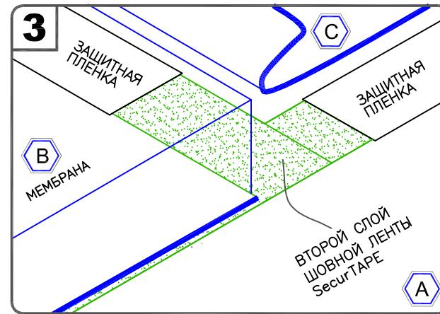
СОЕДИНТЕ ПОЛТОН **В** С ПОЛОТНОМ **А** И УЛОЖИТЕ ВТОРУЮ ШОВНУЮ ЛЕНТУ МЕЖДУ ПОЛОТНАМИ **В** И **С**. ОТРЕЖЬТЕ ЗАЩИТНУЮ ПЛЕНКУ КАК ПОКАЗАНО НА РИСУНКЕ
