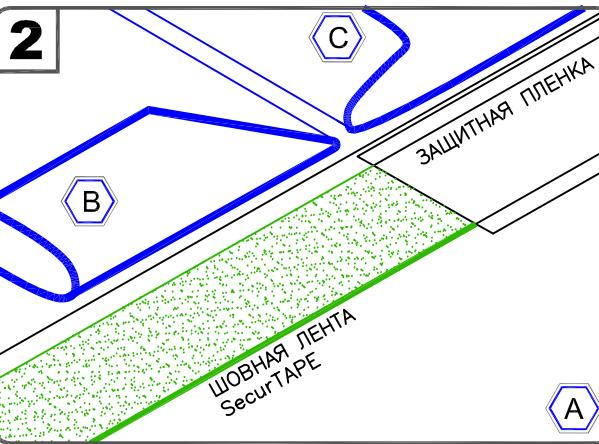
ЗАВЕРНИТЕ ВЕРХНИЕ ПОЛОТНА МЕМБРАНЫ КАК ПОКАЗАНО НА РИСУНКЕ. НАНЕСИТЕ ПРАЙМЕР ЭПДМ НА ОБЕ ПОВЕРХНОСТИ В ОБЛАСТИ ШВА И ДАЙТЕ ВЫСОХНУТЬ ДО СОСТОЯНИЯ, КОГДА ПРАЙМЕР СЛЕГКА ПРИЛИПАЕТ ПРИ КАСАНИИ ПАЛЬЦЕМ Но НЕ ТЯНЁТСЯ ВСЛЕД ЗА ПАЛЬЦЕМ. УЛОЖИТЕ ШОВНУЮ ЛЕНТУ ВДОЛЬ ЛИНИИ РАЗМЕТКИ.
